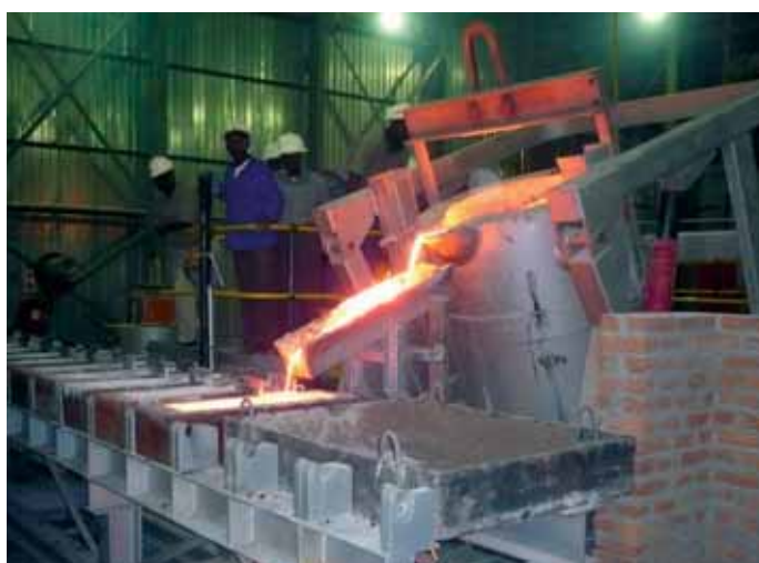
Pouring blister copper, DRC
